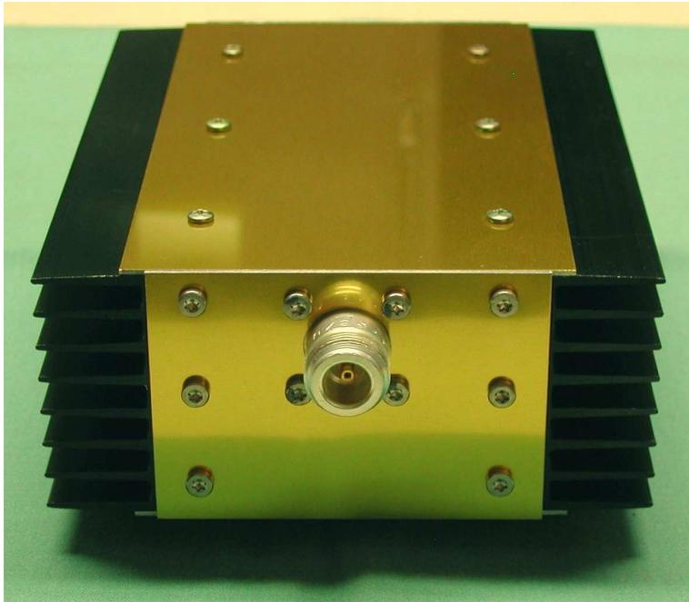
Abb. 9: Das fertige Dämpfungsglied
