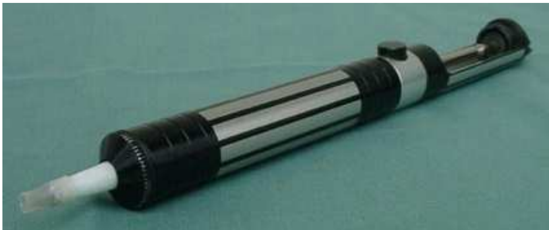
Abb. 1: Der Löt-sauger mit dem Silikonschlauch als Schutz und Verlängerung der Teflonspitze
