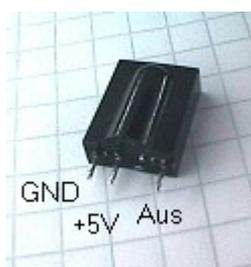
Mancher wird sich nun fragen: Geht das nicht auch ohne einen Computer? Klar geht das! Allerdings reagiert eine einfache Schaltung nicht auf eine bestimmte Taste, sondern auch jede. Der Infrarotempfänger entlädt den Kondensator. Dann sperrt der erste Transistor, und der zweite leitet. Die Lampe bleibt noch einige Zeit an und geht dann von allein wieder aus.
