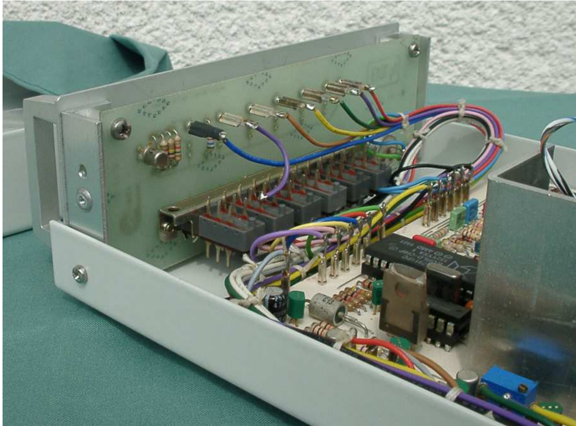
Abb. 7: Ein fertiges, geöffnetes Gehäuse; auch der Kabelbaum ist zu erkennen
